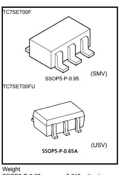
SSOP5-P-0.95 : 0.016 g (typ.) SSOP5-P-0.65A : 0.006 g (typ.)
