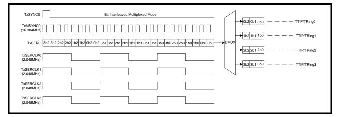
FIGURE 26. RECEIVE HIGH-SPEED BIT MULTIPLEXED BLOCK DIAGRAM
