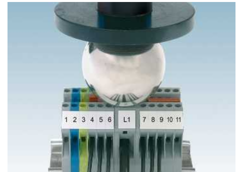
Test ball Ø 50 mm
