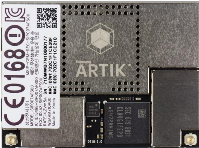
ARTIK 710 Module Top View
