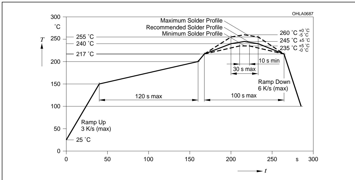
**Wellenlöten (TTW)<sup>9)</sup> Seite 17****TTW Soldering<sup>9)</sup> page 17**
