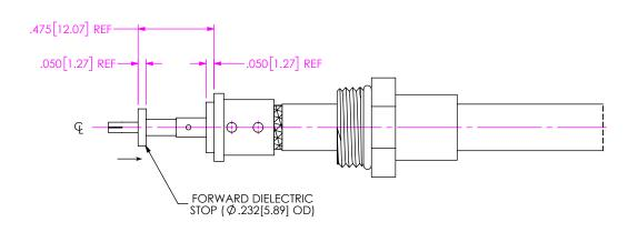
4. SLIDE FORWARD DIELECTRIC STOP ONTO CONTACT. AGAINST SHOULDER AS SHOWN.
