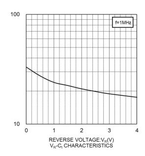
CAPACITANCE BETWEEN TERMINALS:C<sub>((PF)</sub>
