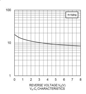
CAPACITANCE BETWEEN TERMINALS:C<sub>t</sub>(pF)
