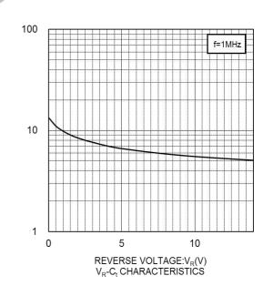
CAPACITANCE BETWEEN TERMINALS:C<sub>t</sub>(pF)
