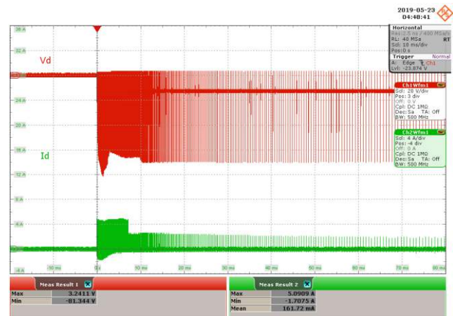
Figure 70 – 265 VAC 50 Hz. CH1: V_D , 20 V / div., 10 ms / div. CH2: I_D , 4 A / div., 10 ms / div. PIV = 81.344 V, I_{D(MAX)} = 5.0909 A.
