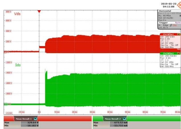
Figure 48 – 115 VAC 60 Hz. CH1: V_{DS} , 200 V / div., 10 ms / div. CH2: I_{DS} , 200 mA / div., 10 ms / div. V_{DS(MAX)} = 329.64\text{ V} , I_{DS(MAX)} = 673.52\text{ mA} .
