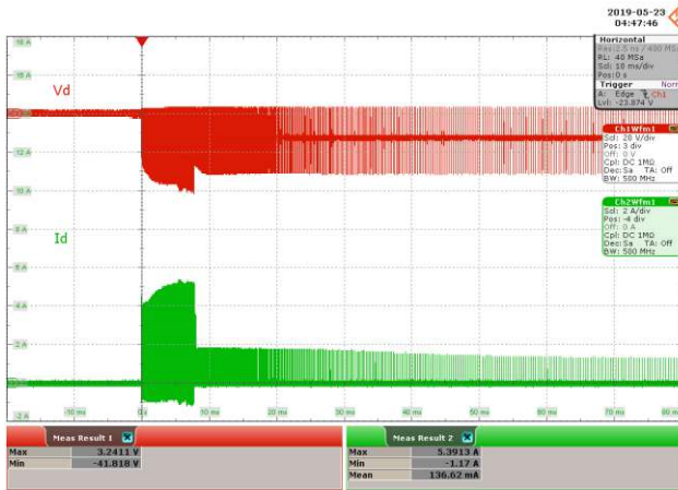
Figure 67 – 85 VAC 60 Hz. CH1: V_D , 20 V / div., 10 ms / div. CH2: I_D , 2 A / div., 10 ms / div. PIV = 41.818 V, I_{D(MAX)} = 5.3913 A.
