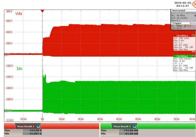
Figure 50 – 265 VAC 50 Hz. CH1: V_{DS} , 200 V / div., 10 ms / div. CH2: I_{DS} , 200 mA / div., 10 ms / div. V_{DS(MAX)} = 543.08\text{ V} , I_{DS(MAX)} = 744.66\text{ mA} .
