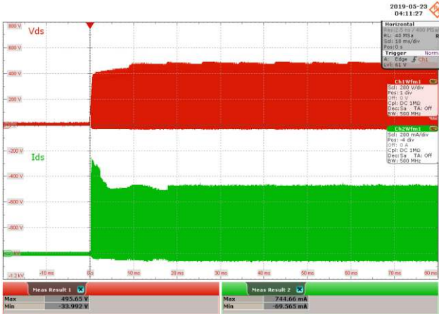
Figure 49 – 230 VAC 50 Hz. CH1: V_{DS} , 200 V / div., 10 ms / div. CH2: I_{DS} , 200 mA / div., 10 ms / div. V_{DS(MAX)} = 495.65\text{ V} , I_{DS(MAX)} = 744.66\text{ mA} .
