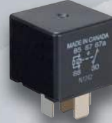
G8JN(1a/1c) MINI ISO Rated 35 A/20 A Inrush 120 A/40 A
