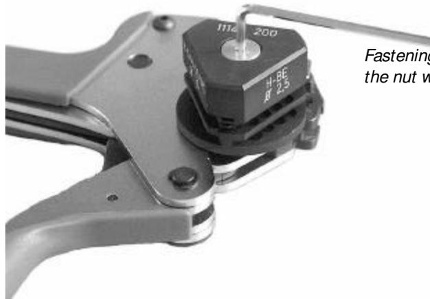
Befestigen des Locators durch Anziehen der Mutter mit dem Inbusschlüssel
