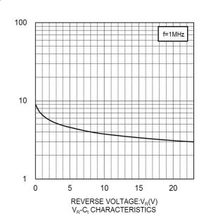
CAPACITANCE BETWEEN TERMINALS:C<sub>t</sub>(pF)
