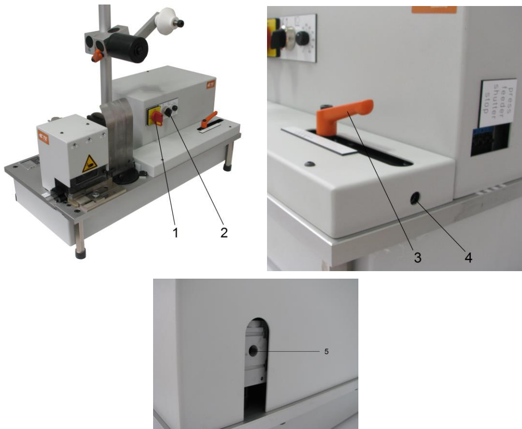
Abb. 22: Einstellung des Vorschubzylinders
