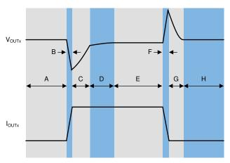
Figure 8-9. Load Transient Waveform
