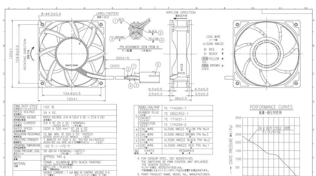
IP68 (IEC 60529:2001) NOTE: 1. MEASURED AT 1 m DISTANCE FROM THE AIR INLET. ファン吸込側より1 mにて測定する。
