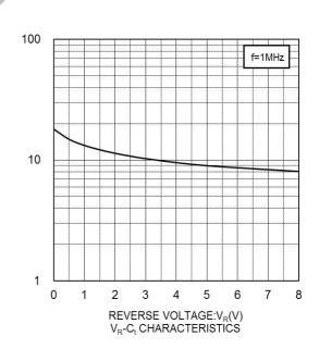
CAPACITANCE BETWEEN TERMINALS:C<sub>t</sub>(pF)
