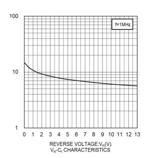
CAPACITANCE BETWEEN TERMINALS:C<sub>t</sub>(pF)
