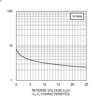
CAPACITANCE BETWEEN TERMINALS:C<sub>t</sub>(pF)
