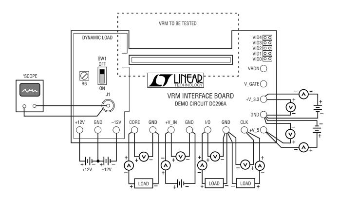
Figure 1. DC296A Hookup Diagram
