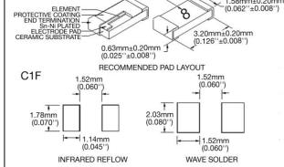
RECOMMENDED SOLDER PASTE THICKNESS: 0.15mm minimum
