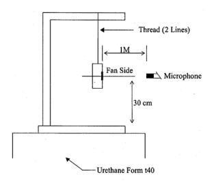
1 METER FROM MICROPHONE TO FAN INTAKE
