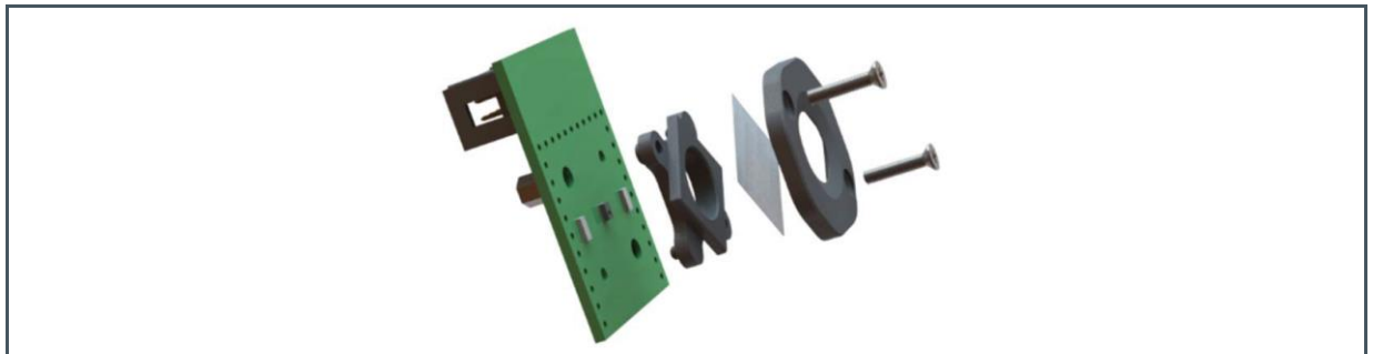
Figure 19: Installation of Diffusor Holder ALS (1)
