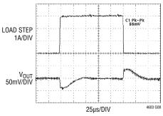
3.3V AT 3A/ $\mu$ s LOAD STEP C<sub>OUT</sub>: 1 $\times$  22 $\mu$ F, 6.3V CERAMIC 1 $\times$  330 $\mu$ F, 4V SANYO POSCAP
