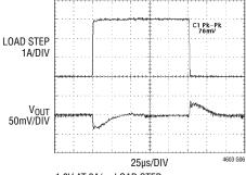
1.8V AT 3A/ $\mu$ s LOAD STEP C<sub>OUT</sub>: 1× 22 $\mu$ F, 6.3V CERAMIC 1× 330 $\mu$ F, 4V SANYO POSCAP
