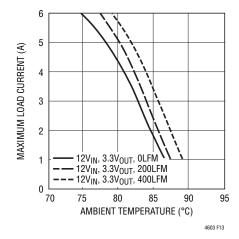
Figure 13. 12V<sub>IN</sub>, 3.3V<sub>OUT</sub> No Heat Sink
