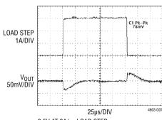
2.5V AT 3A/µs LOAD STEP C<sub>OUT</sub>: 1× 22µF, 6.3V CERAMIC 1× 330µF, 4V SANYO POSCAP
