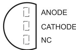
LM285-1.2, LM385-1.2, LM385B-1.2 . . . LP PACKAGE (TOP VIEW)
