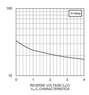
CAPACITANCE BETWEEN TERMINALS:C<sub>((PF)</sub>
