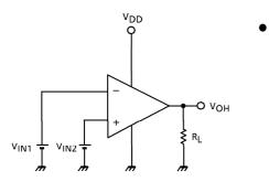
• V<sub>OH</sub> V<sub>IN1</sub> =  $\frac{V_{DD}}{2}$  - 0.05V V<sub>IN2</sub> =  $\frac{V_{DD}}{2}$  + 0.05V
