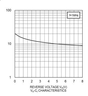
CAPACITANCE BETWEEN TERMINALS:C<sub>t</sub>(pF)
