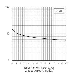
CAPACITANCE BETWEEN TERMINALS:C<sub>t</sub>(pF)
