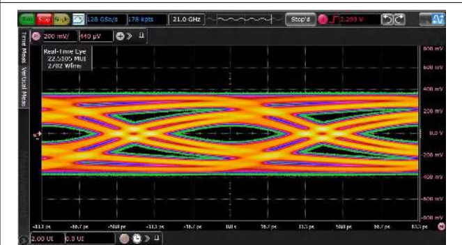
Figure 9-6. 12 Gbps Input Eye at TTP2 After Pre-channel
