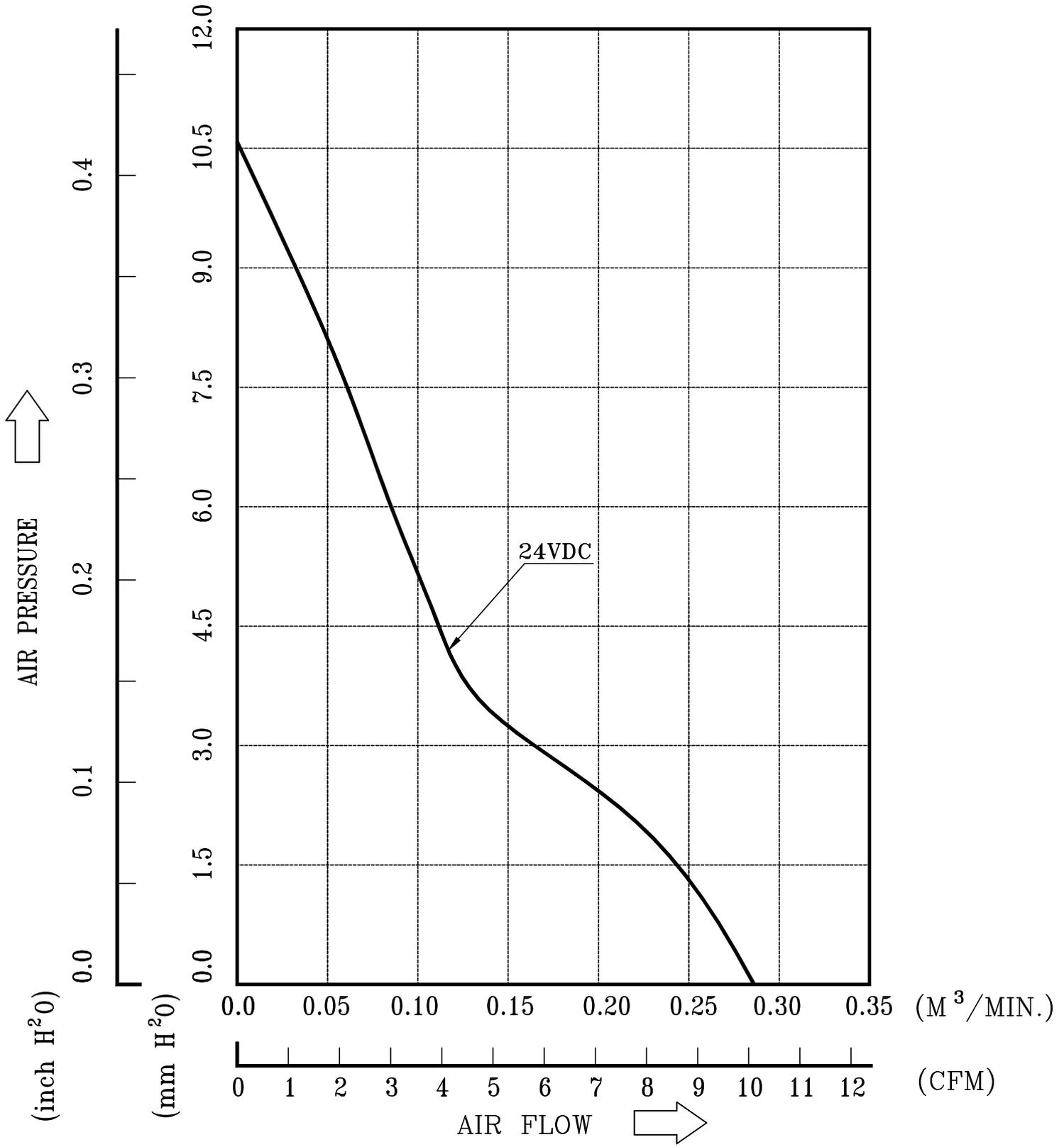
\* TEST CONDITION: INPUT VOLTAGE ——— OPERATION VOLTAGE
