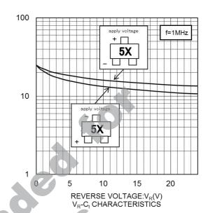
CAPACITANCE BETWEEN TERMINALS:C<sub>f</sub>(pF)
