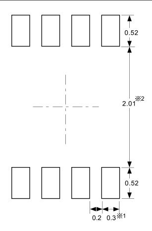
※1. ランドパターンの幅に注意してください (0.25 mm min. / 0.30 mm typ.)。 ※2. パッケージ中央にランドパターンを広げないでください (1.96 mm ~ 2.06 mm)。
