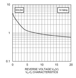
CAPACITANCE BETWEEN TERMINALS:C<sub>i</sub>(pF)
