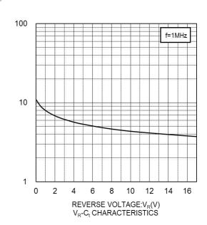
CAPACITANCE BETWEEN TERMINALS:C<sub>t</sub>(pF)
