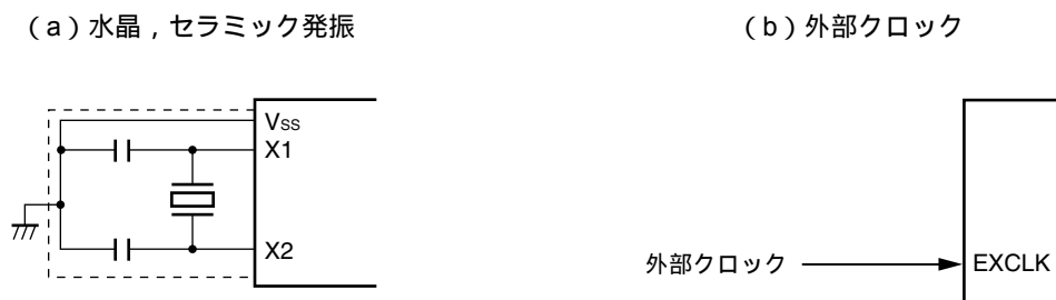
図6-12 X1発振回路の外付け回路例
