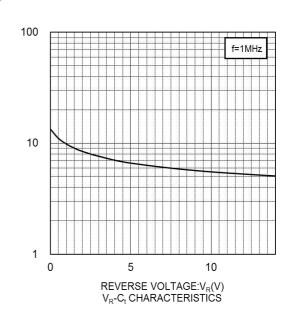
CAPACITANCE BETWEEN TERMINALS:C<sub>t</sub>(pF)
