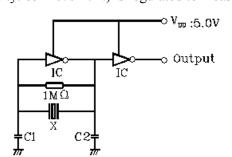
X: Ceramic Resonator C1=C2: 10pF ±20% (20.00MHz~25.99MHz) 5pF ±20% (26.00MHz~35.00MHz) 5pF ±20% (35.01MHz~60.00MHz)
