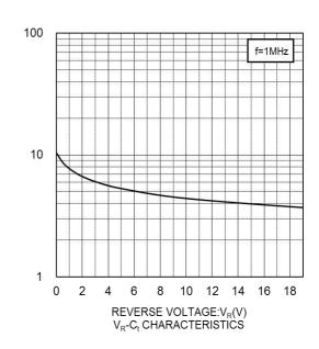
CAPACITANCE BETWEEN TERMINALS:C<sub>t</sub>(pF)
