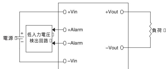
低入力検出出力端子 ( $\pm$ Alarm) はフォトカプラのトランジスタ出力で、入力側、出力側とも絶縁されております。
