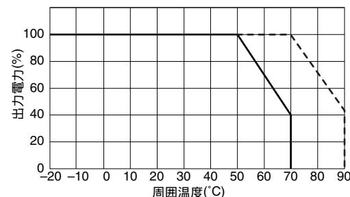
・ケース表面温度で規定する場合、破線の範囲を適用して下さい。
