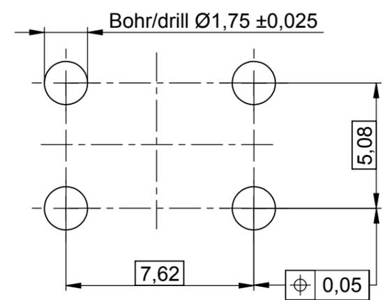
**Enddurchmesser metallisiert mit min. Cu 25µm**
