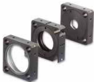
Ungefasste Rundoptiken mit verschiedenen Durchmessern in Vorschraubringen gefasst und in Aufnahmeplatten M35x0.5 der Mikrobank geschraubt. Unmounted spherical optics with different diameters integrated into threaded retaining rings and screwed into Microbench mounting plates M35x0.5.
