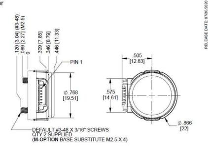
H-OPTION COVER (COVER HOLE FOR EXTENDED SHAFTS)
