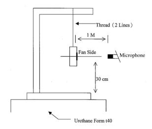
1 METER FROM MICROPHONE TO FAN INTAKE
