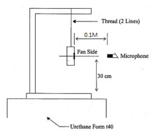
0.1 METER FROM MICROPHONE TO FAN INTAKE
