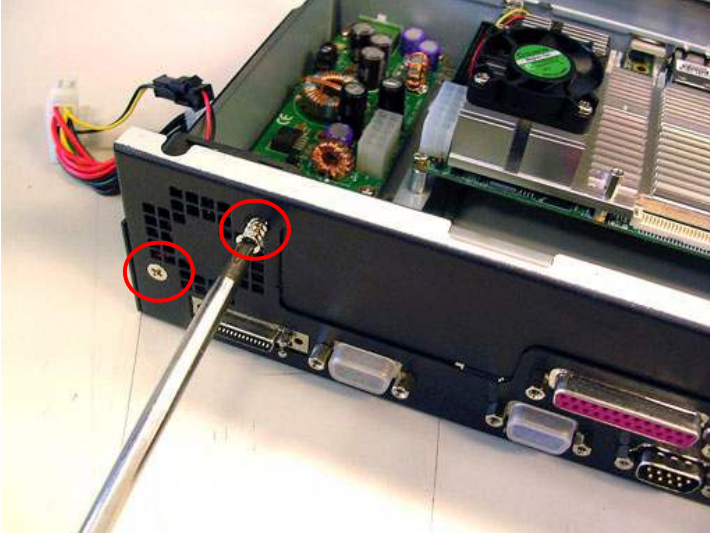
Figure 5.6: Remove the FAN module
