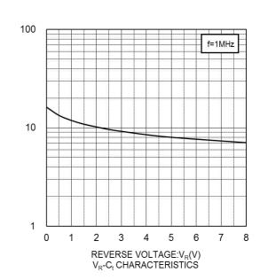
CAPACITANCE BETWEEN TERMINALS:C<sub>t</sub>(pF)
