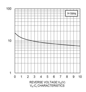
CAPACITANCE BETWEEN TERMINALS:C<sub>t</sub>(pF)
