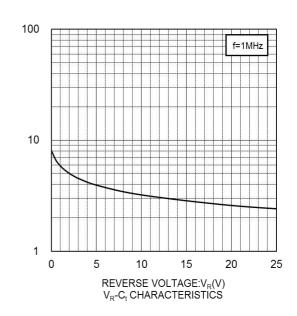
CAPACITANCE BETWEEN TERMINALS:C<sub>t</sub>(pF)
