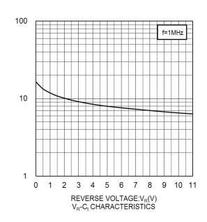
CAPACITANCE BETWEEN TERMINALS:C<sub>t</sub>(pF)
